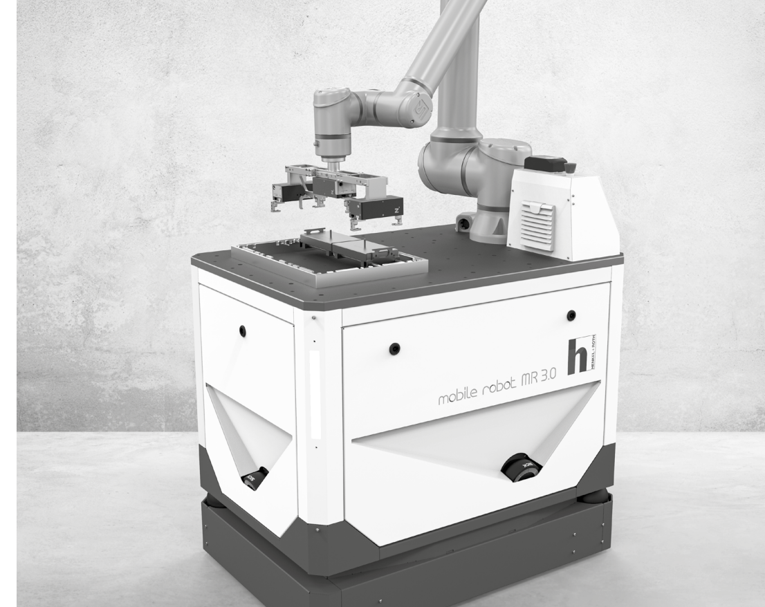
Bild 1: Mobiler Manipulator „Mobile Robot 3.0“ (MR3.0) mit Handhabungssystem für Vorrichtungen, Quelle: Henkel + Roth GmbH
