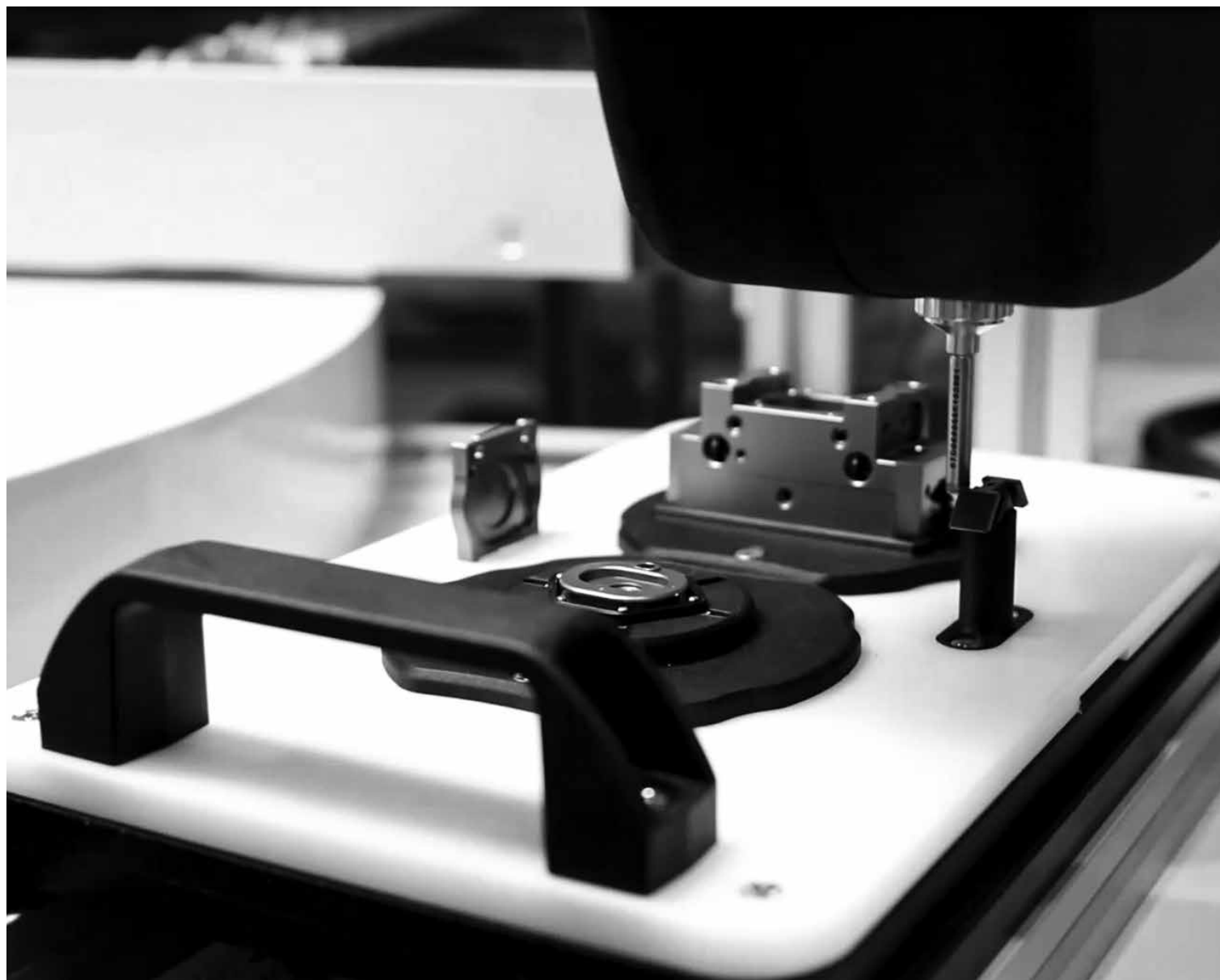
Bild 2: Vorrichtung mit aufgelegtem O-Ring und Bauteilen, Quelle: SCHUNK GmbH &amp; Co. KG
