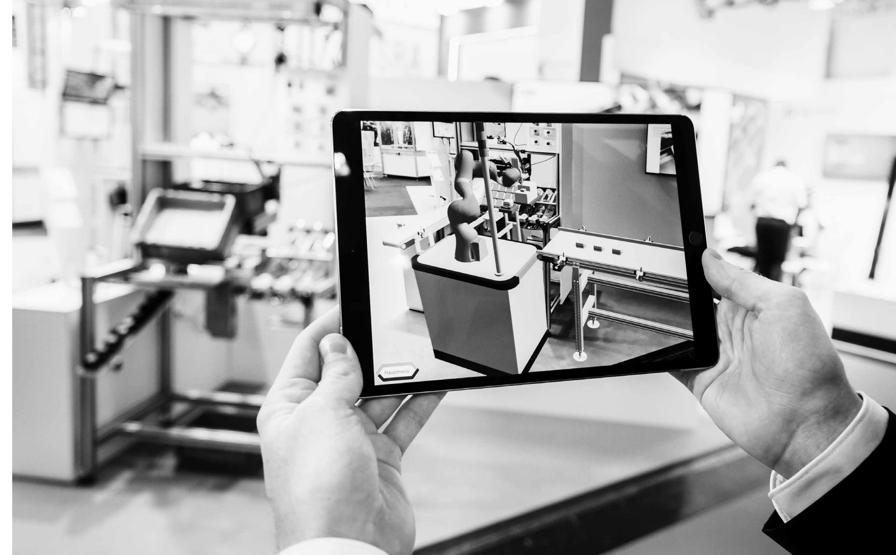
Bild 3: Der simulierte Arbeitsplatz in der AR-Anwendung Quelle: Ruhr-Universität Bochum, Lehrstuhl für Produktionssysteme
